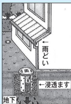
「雨水浸透ます」とは、建物の屋根に降った雨水を地下に浸透させるための設備です。
