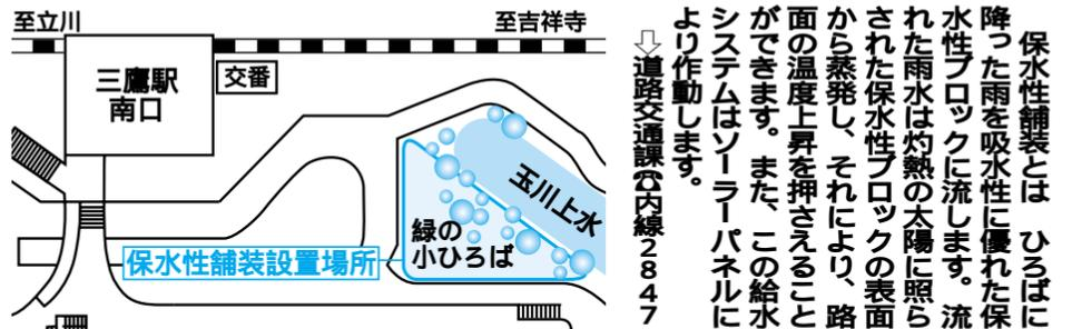
保水性舗装とは、ひろばに降った雨を吸水性に優れた保水性ブロックに流します。流れた雨水は灼熱の太陽に照らされた保水性ブロックの表面から蒸発し、それにより、路面の温度上昇を抑えることができます。また、この給水システムはソーラーパネルにより作動します。
