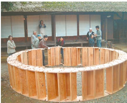
出来上がった水輪の部材を並べてみたところ。直径は4.6メートル
