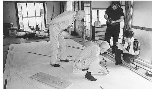
実寸の図面作り。ベニヤ板4枚を合わせてやっとならば水車の半分が描ける
