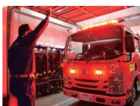
▲ポンプ車のライトやサイレンなどの動作確認
