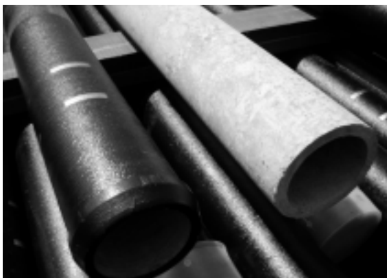
ダクタイル鑄鉄管（左）と石綿セメント管（右）
